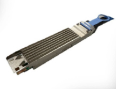
Amphenol OSFP-XD 铜电缆组件
